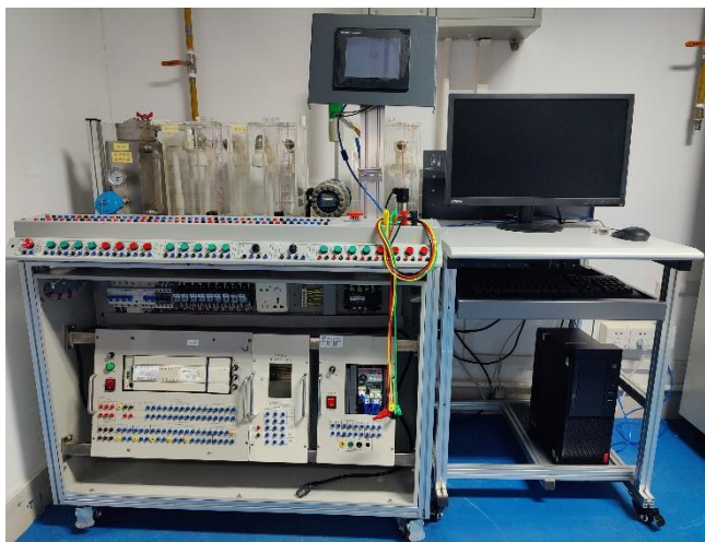
图 4 过程控制及配方实训设备
